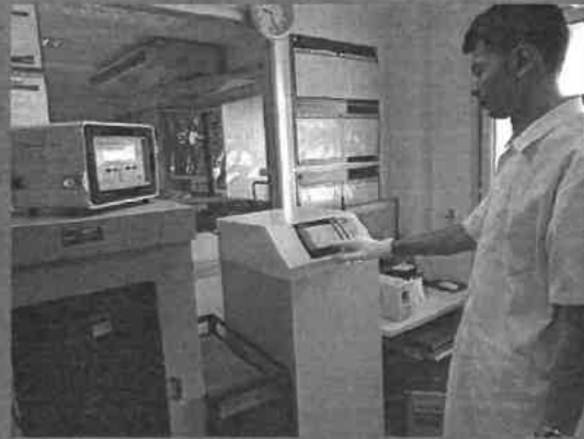
การสอบเทียบเครื่องทดสอบก้อนปูน
